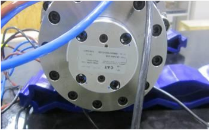
Bild 4.2: Makroaufnahme der Drehdurchführung / extreme close-up rotary of the transmission leadthrough / giunto rotante
